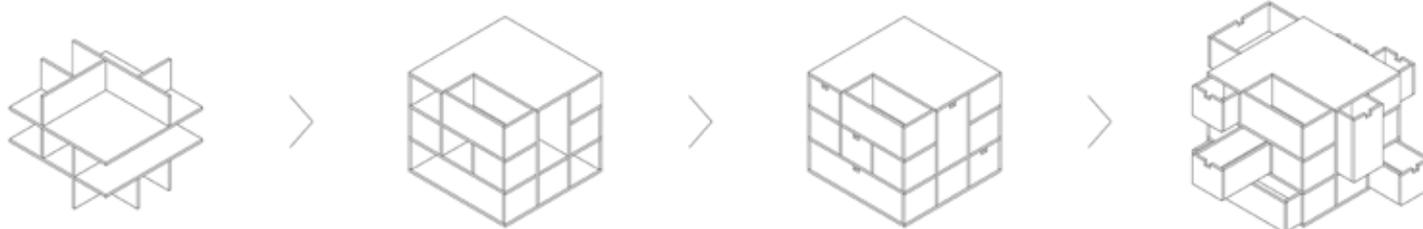
>> Acima: Esquema com as etapas de montagem da Caixa de Memórias, executada em peças de mdf (6mm), encaixadas e coladas. As primeiras peças, encaixadas, formam o "miolo", seguindo-se ao fechamento externo e ao encaixe das gavetas.
