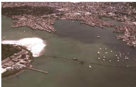
Figura 29 – Salvador, Bahia, Alagados, 1975 – vista aérea do aterro de Joanes em fase de execução e tubulação flutuante de recalque .
